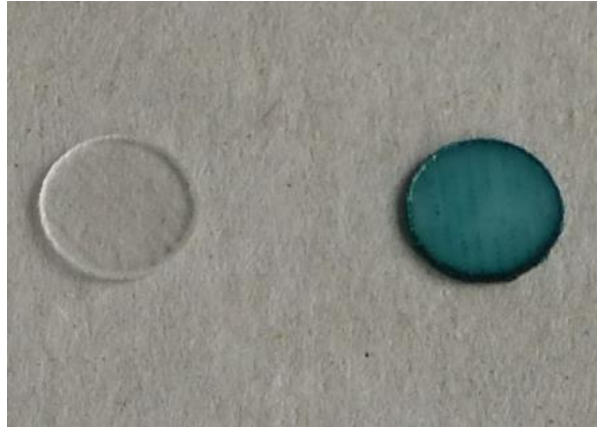
Abbildung 19: 3D-gedruckte Probepfannchen ohne (links) und mit (rechts) immobilisierter Meerrettichperoxidase nach Entwicklung in einer ELISA-Substratlösung mit Tetramethylbenzidin (TMB).
