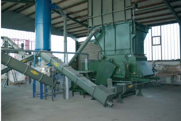
Bild 4: Vorbehandlungsanlage für Dünnschichtmodule, Teilprojekt Accurec Recycling GmbH [Photorec]
