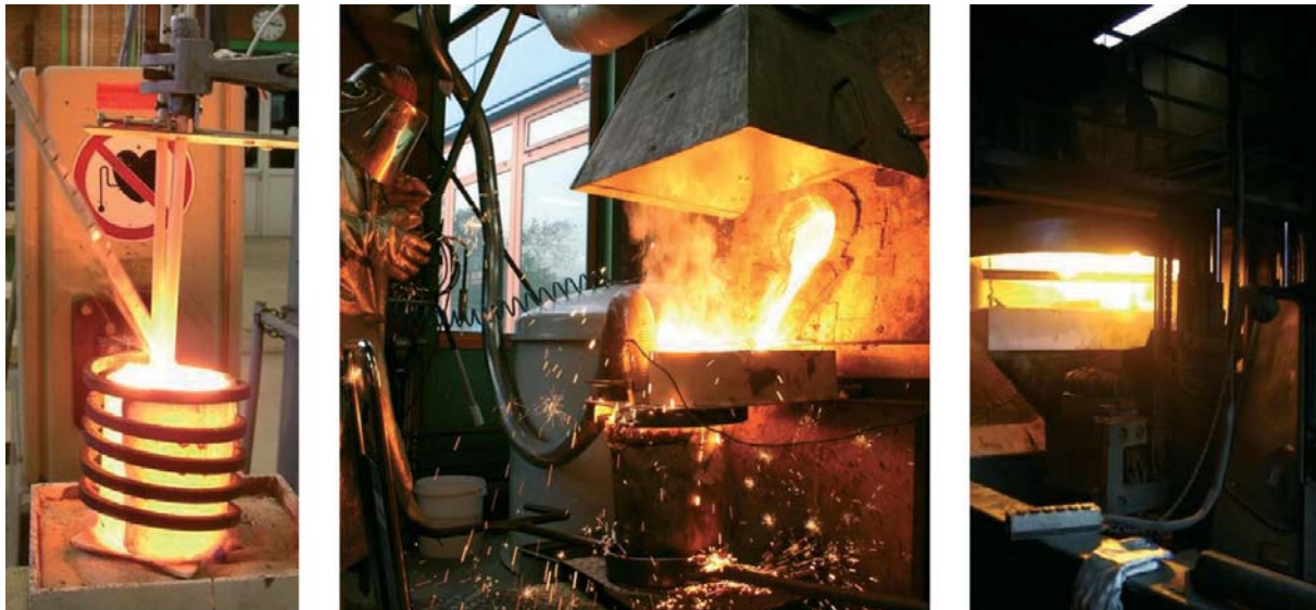
Bild 2: Entschwefelungsversuche unter Labor- (a), Technikums- (b) und Betriebsbedingungen (c)
