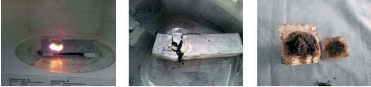
Bild 4: Zementleimprisma mit 10 Ma.-% SiC nach der Mikrowellenbehandlung mit Reduktionskern im Inneren und vollständig zersetztem Baustoff (Foto: Weiß 2016)
