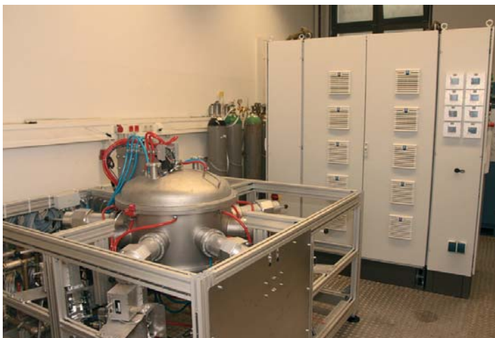
Bild 3: MVD-Anlage der Firma Fricke und Mallah Microwave Technology GmbH am IME in Aachen [Photorec]
