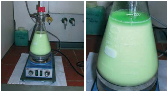
Bild 4: Laboraufbau der Behandlung zur Phasentrennung / Bild 5: Zu Beginn der Sedimentation (Foto: Grüning)
