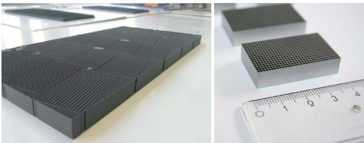
Bild 5: Gedruckte, ungesinterte Bauteile (Quelle: Fraunhofer IFAM Dresden)
