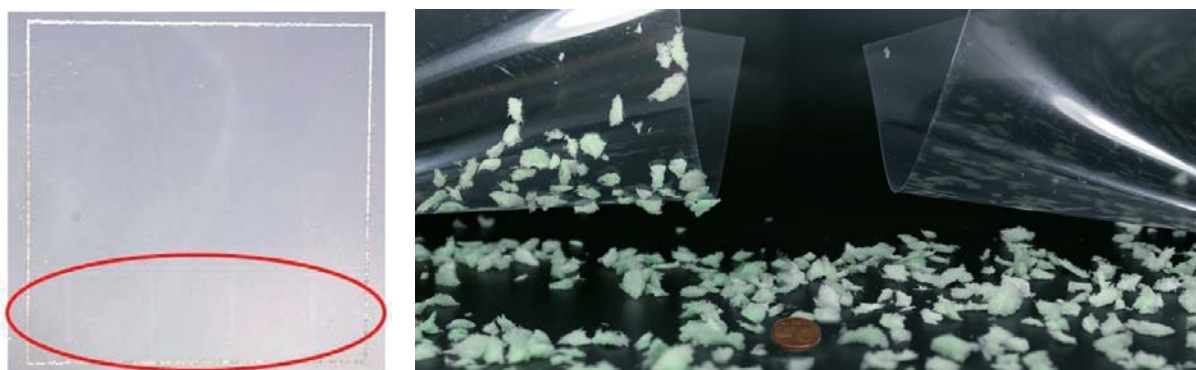
Bild 4: Laserstrukturierung von FTO-PET-Folie (links) sowie antistatische Eigenschaften einer CNT-PET-Folie im Vergleich zu einer unveredelten PET-Folie (rechts) (Quelle: Fraunhofer IWS)
