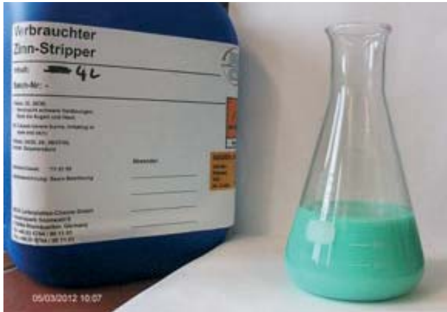
Bild 1: Verbrauchte Zinn-Stripperlösung aus der BECE-Produktion (Foto: Grüning)
