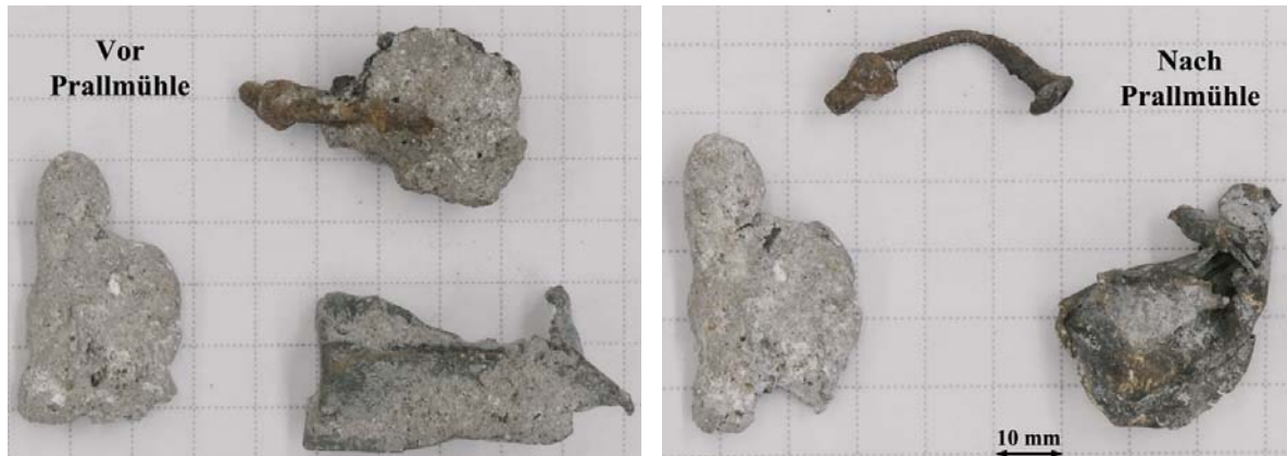
Bild 7: NE-Metallpartikel mit oberflächlichen Mineralverschmutzungen (links) und nach mechanischer Reinigung in einer Prallmühle (rechts) (Foto: Rübmann)
