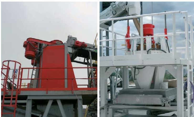
Bild 2: Im Rahmen des Projektes (weiter-)entwickelte TAR-Prozessoren (Hochgeschwindigkeits-Rotations-Beschleuniger) zum Prallaufschluss von HMVA: Alpha-Linie (links) und Beta-Linie (rechts) (Quellen: BAM, Holm (links), SRH, Lübben (rechts))
