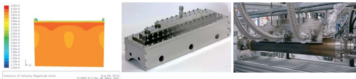
Bild 5: Simulation der Strömungsverhältnisse in der Schlitzdüse am Düsenausgang (links), CVD-Beschichtungskopf (Mitte) und CVD-Modul und Substratheizung in Laboranlage (rechts) (Quelle: Fraunhofer IWS)
