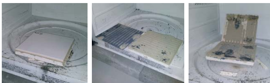
Bild 9: Probekörper mit Fliesen vor und nach der Mikrowellenbehandlung (Foto: IAB)
