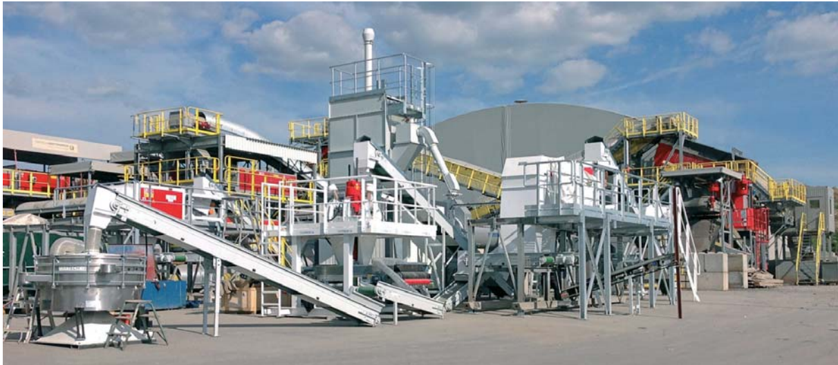
Bild 1: Ansicht der Aufbereitungsanlage für Hausmüllverbrennungsaschen (HMVA) in Wiesbaden: Alpha-Linie im Hintergrund, Beta-Linie (weiß) im Vordergrund (Quelle: TARTECH AG Gronholz)
