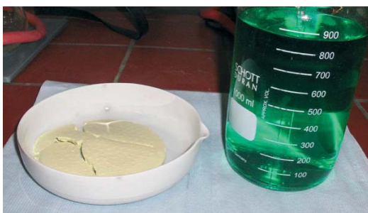
Bild 7: Zinnreiche Festphase und kupferreiche Flüssigphase nach Separation (Foto: Grüning)
