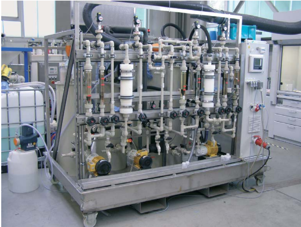
Bild 4: Technikumsanlage im BFI mit Membrankontaktoren zur Extraktion und Re-Extraktion (Quelle: BFI, R. Wolters)
