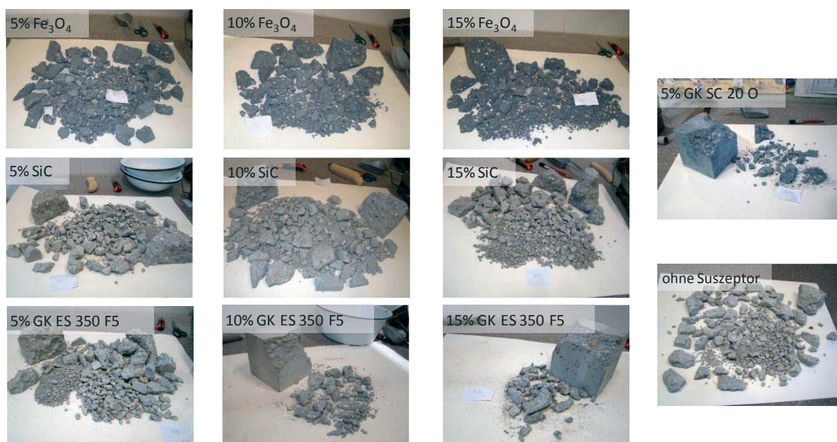
Bild 3: Zerkleinerungsgut der Betonwürfel nach der Mikrowellenbehandlung (Foto: Weiß 2016)
