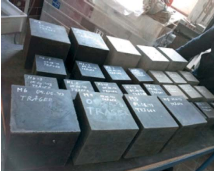
Bild 1: Betonwürfel 15 cm x 15 cm mit unterschiedlichen Suszeptorgehalten (Foto: Weiß 2016)
