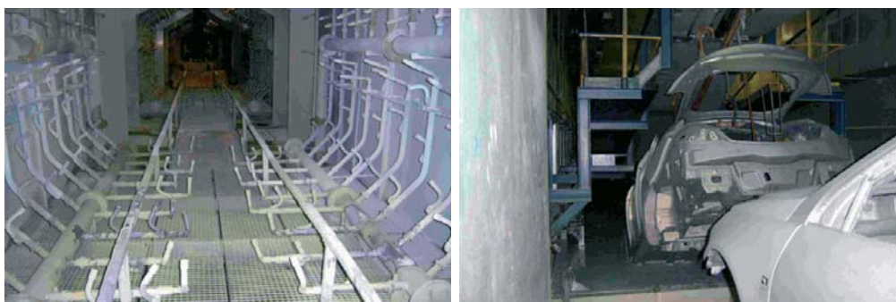
Bild 1: Phosphatierungslinie mit Spülstufen und KTL-Tauchbecken (Quelle: Adam Opel)
