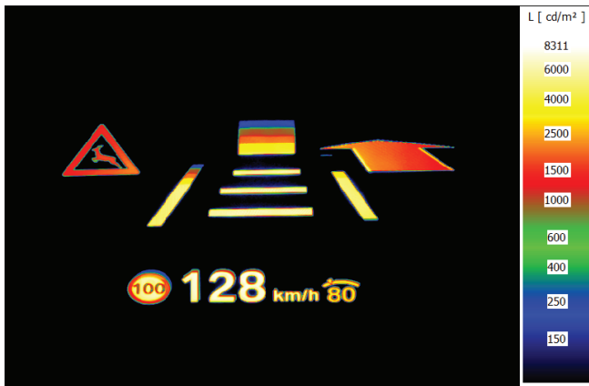
Abbildung 5.39: Leuchtdichte des virtuellen Bildes in der rechten Eye-box bei Darstellung einer Beispielszene in logarithmischer Skala über zwei Dekaden. Die einzelnen Elemente im Bild wurden von der Firma BMW zur Verfügung gestellt [102].
