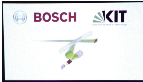
Abbildung 4.13: Mehrfarbiges Testbild des realisierten Prototypen eines DLP-basierten Laserprojektors. Um den durch das Laserlicht bedingten, verfälschenden Weißabgleich der Kameraaufnahme zu korrigieren, wurde ein manueller Weißabgleich durchgeführt.
