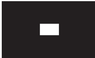
Abbildung 3.3: Testbild der Messung des 4%-Kontrasts. Die weiße Testfläche belegt ein Fünftel der Breite und Höhe des Anzeigebereichs.
