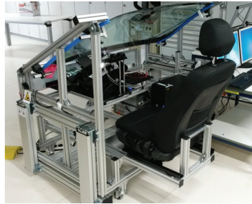
Abbildung 5.23: Abbildung des realisierten Frontscheiben-Prototyps. Der Prototyp ist als Sitzkiste mit Fahrersitz und Serienfrontscheibe aufgebaut [30].
