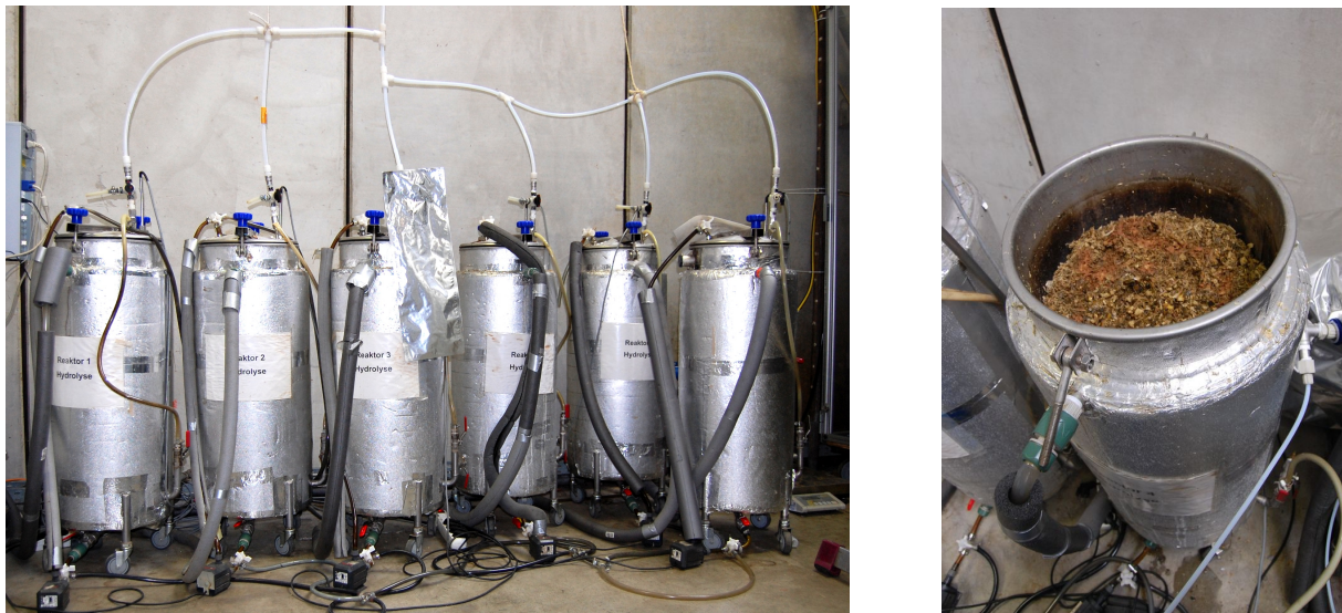
Abbildung 4.11.: Links: parallel geschaltete Batch-Hydrolysereaktoren. Rechts: HR vor Substrataustausch
