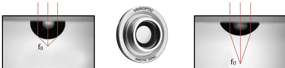
Abbildung 2.16: Flüssiglense basierend auf dem Electrowetting-Effekt
