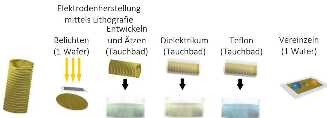
Abbildung 2.31: Skalierbarkeit verschiedener Herstellungsschritte eines DMF-Chips
