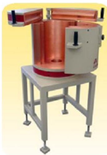
Slika 12. Štit gama detektora
