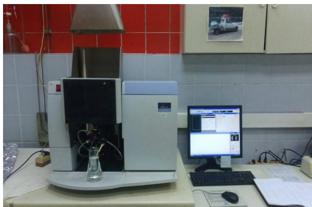
Slika 15. Atomski apsorpcijski spektrometar Perkin Elmer AAAnalyst 400
