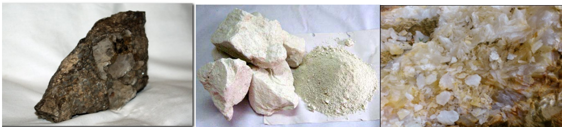
Slika 2.4 Prirodni izgled silika, tatinjca , kaolina i kalcijevog karbonata
