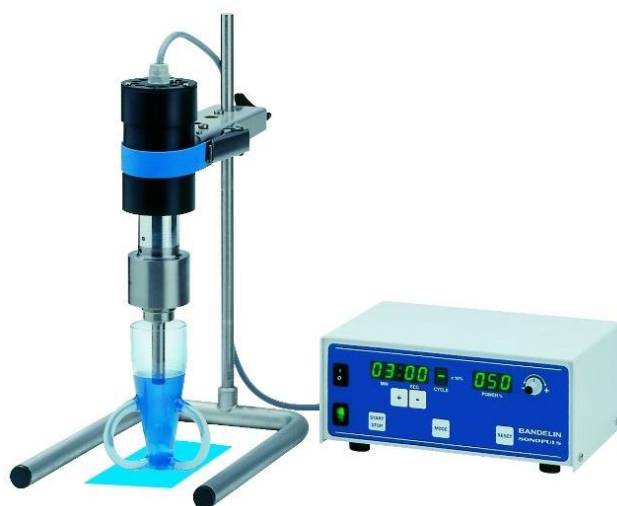
Slika 5. Uređaj za ultrazvučno miješanje.
