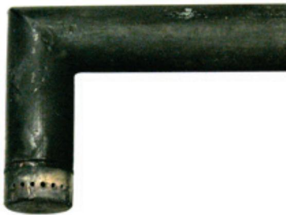
Abbildung B.3.: Foto der gekröpften Propansonde mit Düse zum Einmischen von Sekundärbrennstoff in die REGA
