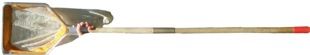
Figura 7: Red tipo Kicknet de 20 cm 2 de área, 250 µm de tamaño de poro y con un mango de 1m de largo.
