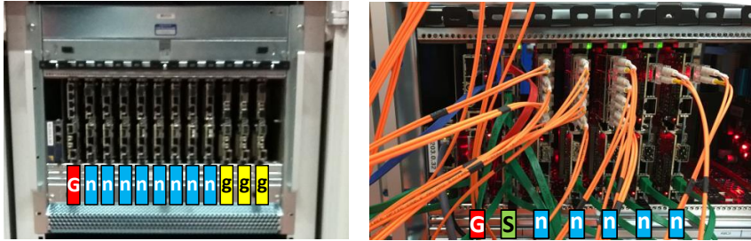
Abbildung 5.10: TS-Systeme im mTCA Crate ohne/mit Verkabelung. Grand- (G, rot), Submaster (S, grün), gDPB (g, gelb), nDPB (n, blau)
