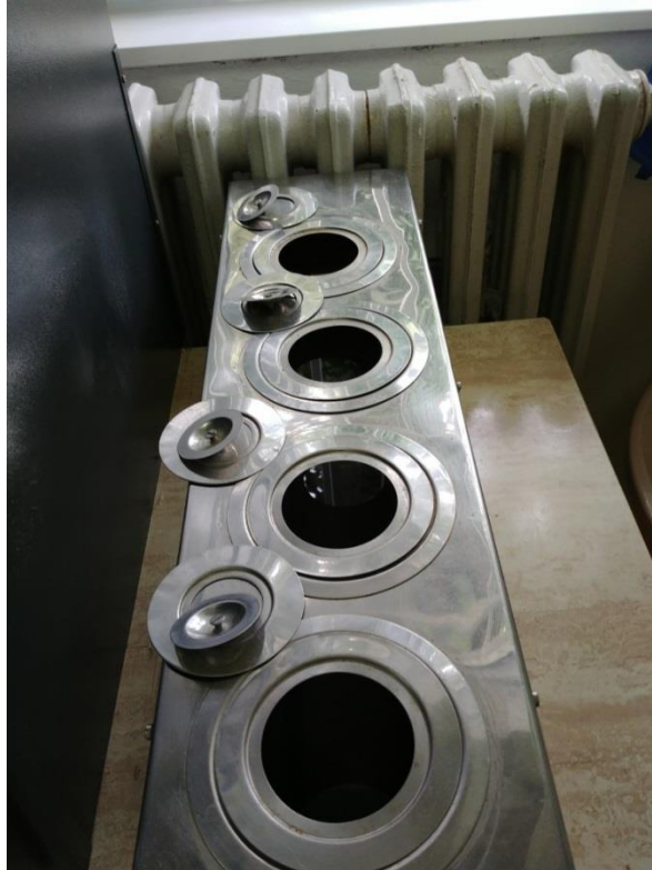
Slika 5. Linija za uparavanje uzorka
