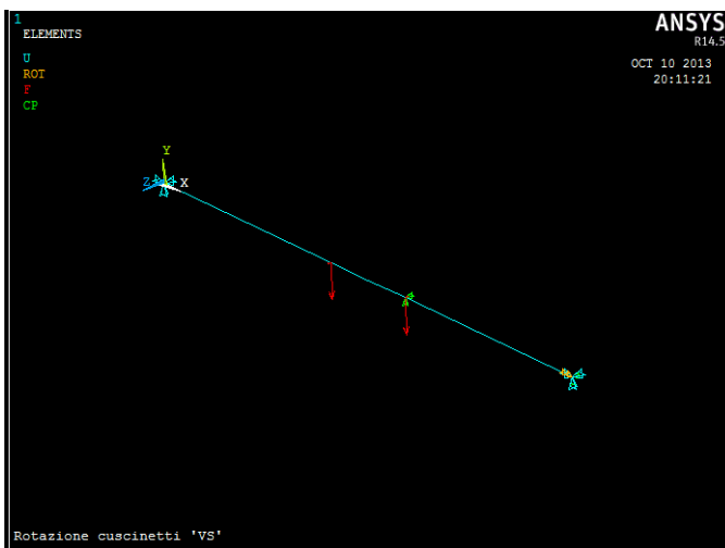
Figura.9.2.27 Schema statico del modello FEM
