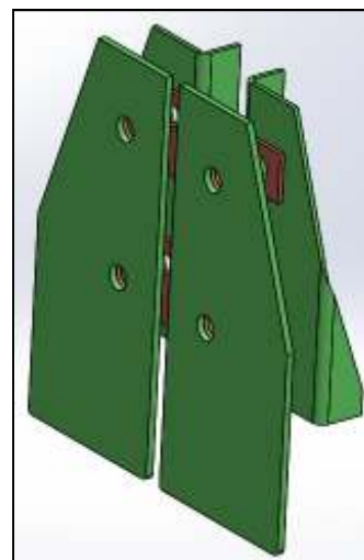
Figura.9.3.25 Lamiera interna ed esterna del gruppo QA
