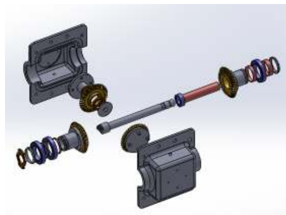
Figura.9.2.45 Vista esplosa del gruppo differenziale
