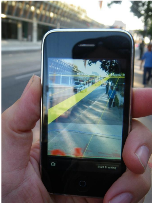
Figura 2.5: Tipico uso della metafora Magic Lenses in una applicazione di Realtà Aumentata per iPhone.
