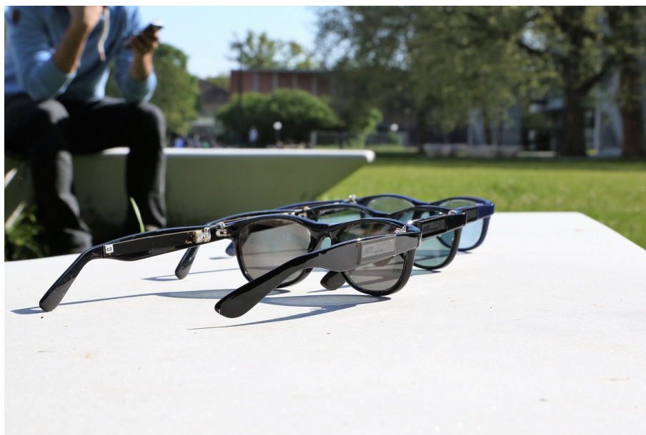
Abbildung 1.1: Die im Rahmen dieser Arbeit mit entwickelten Solarbrillen „Solar Glasses“. Die in den Brillengläsern integrierten organischen Solarzellen liefern auch bei Raumbelichtung genug Energie um die Mikrocontroller-Einheit und die beiden in die Bügel integrierten LCD-Displays zu betreiben. Ziel der Entwicklung dieses Prototypen war die Demonstration der vielfältigen Anwendungsmöglichkeiten organischer Solarzellen.
