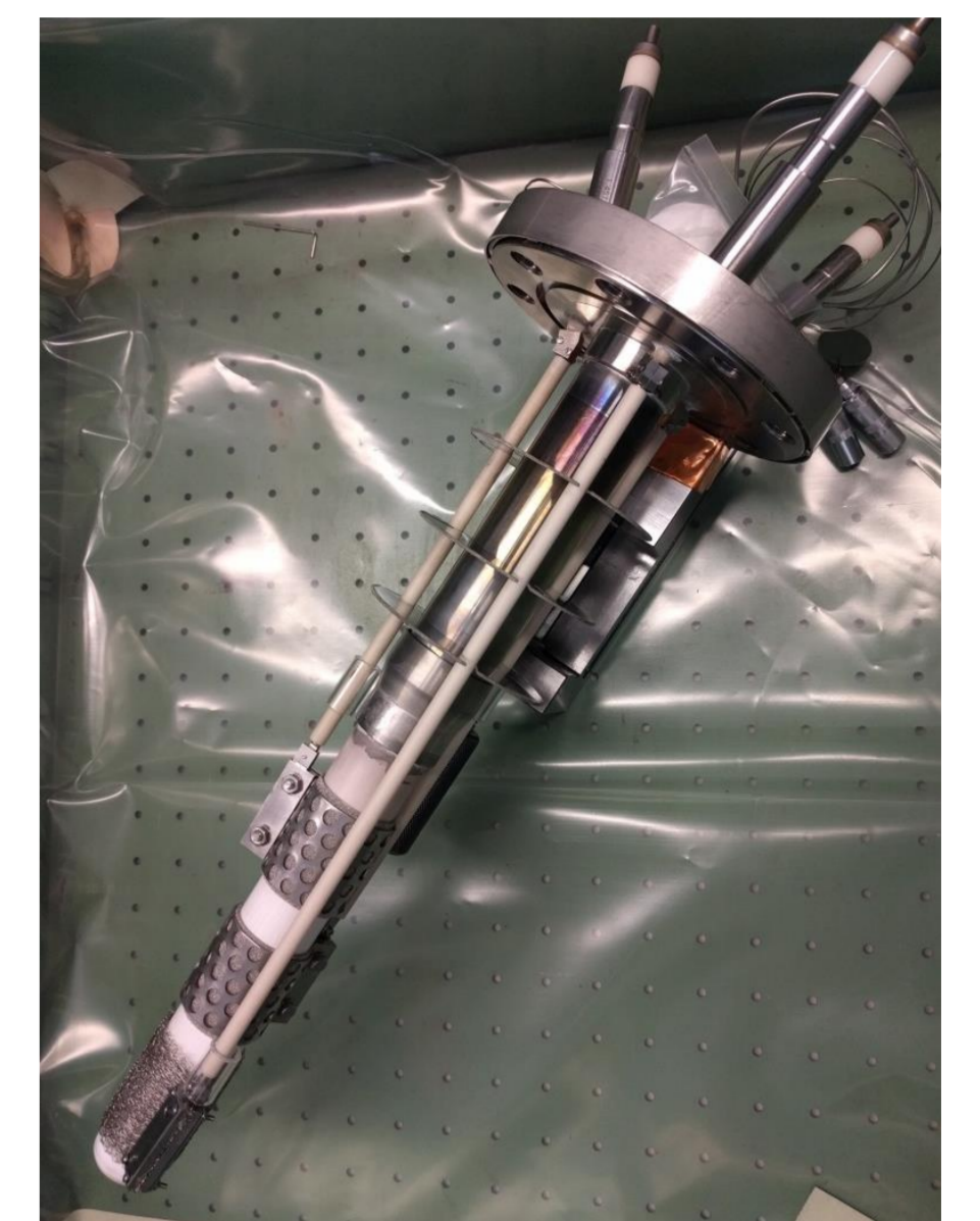
AMTEC Test cell
