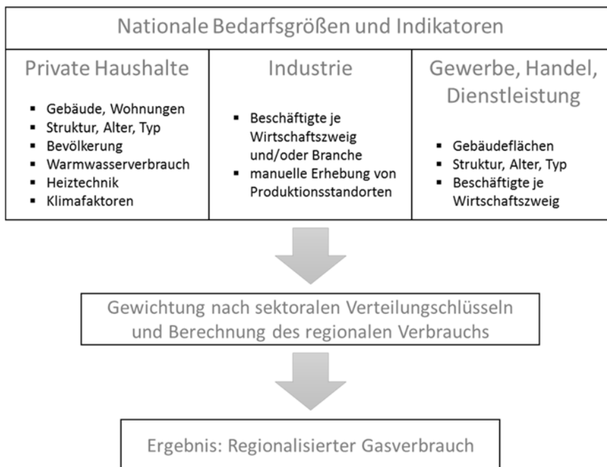
Abbildung 17: Methode für die Berechnung eines regionalen Gasverbrauchs
