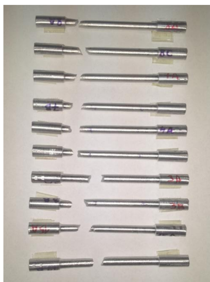
Slika 40. Epruvete nakon statičkog vlačnog ispitivanja
