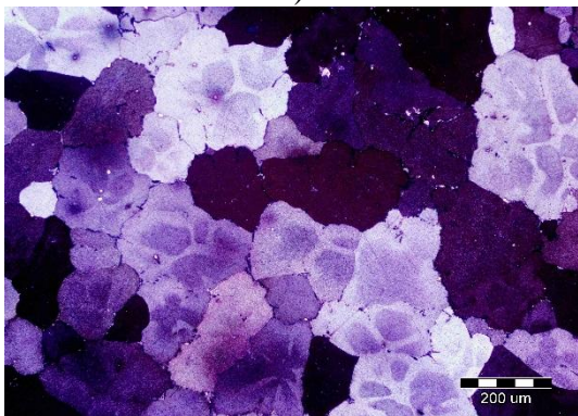
Slika 46. Snimke mikrostrukture uzoraka uzetih iz sredine bloka, 100x a) uzorak 9, b) uzorak 10, c) uzorak 11, d) uzorak 12, e) uzorak 1, f) uzorak 2, g) uzorak 3, h) uzorak 4
