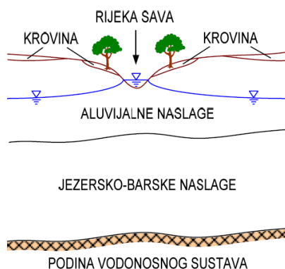
Slika 4-3. Shematski profil zagrebačkog vodonosnog sustava (Posavec, 2006)
