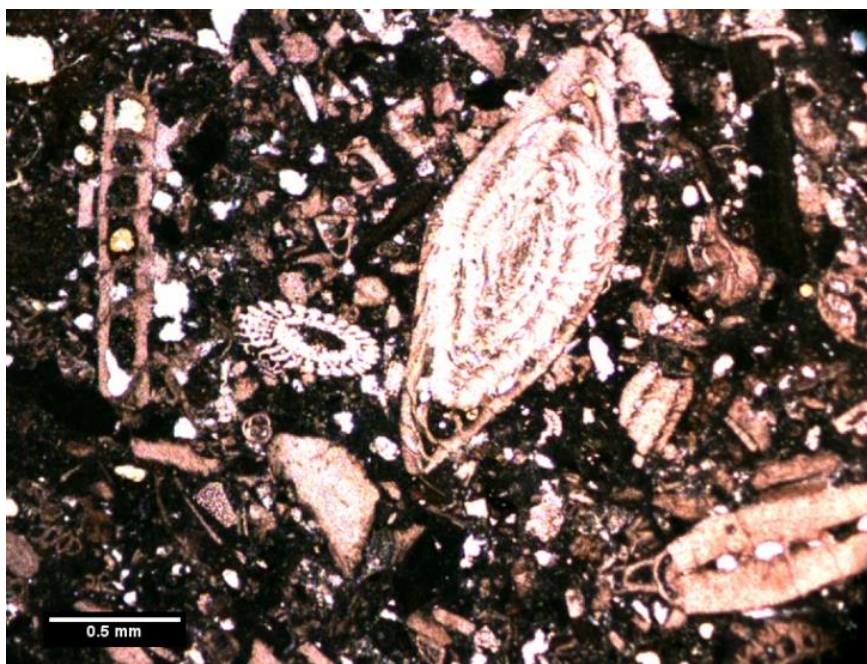
Slika 4-23. Mikrofotografija uzorka M21 - litotamnijski vapnenac
