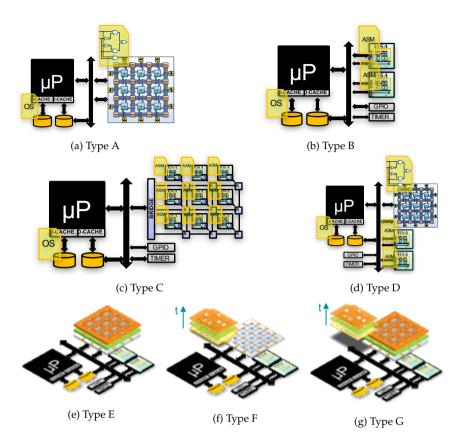
Figure 6.1.: Generic System-on-Chip templates
