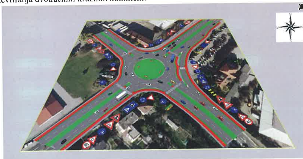
Slika 64. Simulacijski model varijante 2 – dvotračno kružno raskrižje
