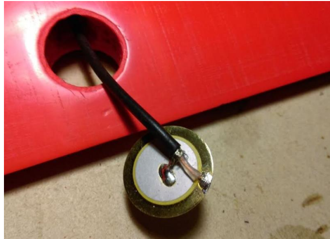
Slika 4.38. Spajanje senzora i koaksijalnog kabla
