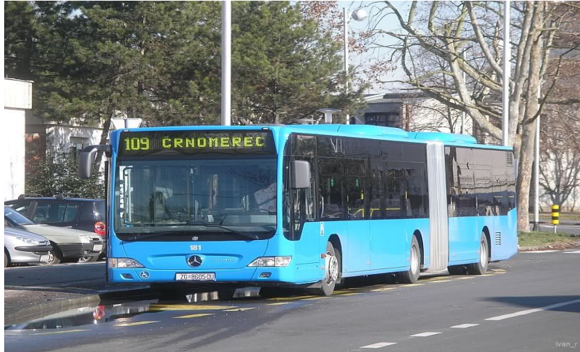
Slika 5. Zglobni autobus Mercedes-Benz Citaro G, [8]
