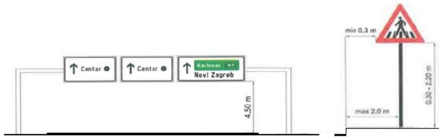
Slika 17. Primjer postavljanja prometnih znakova
