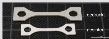
Gedruckte und gesinterte Zugprobe 40 vol% \text{Al}_2\text{O}_3 in ABS
