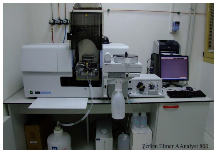
Slika 11. Uređaj Perkin Elmer AAnalyst 800 (spektrometar)
