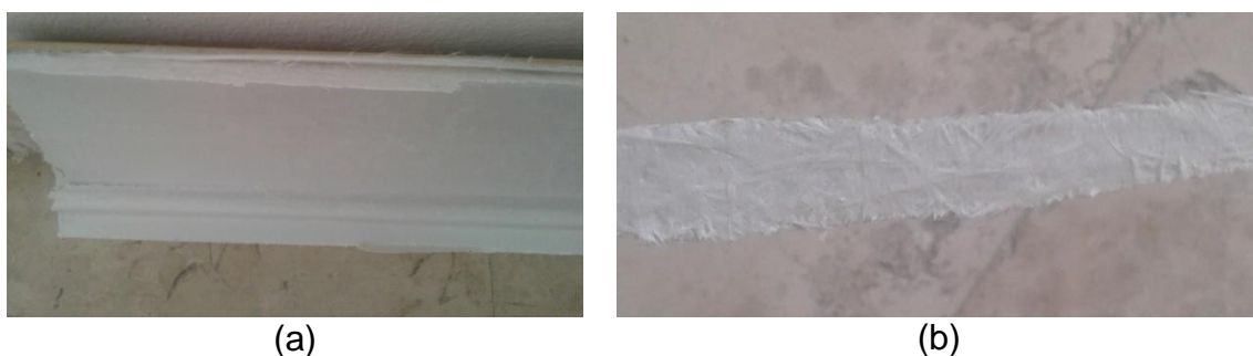
Slika 10. Uzorak stakloplastike (a) dio kade (b) stakleni mat
