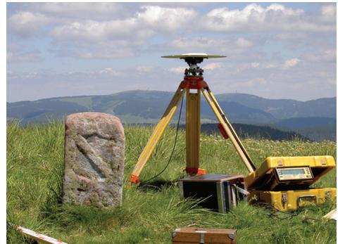
**Abb. 162:** Statische GPS-Messung auf dem Belchen im Jahr 2009 mit einem Trimble 4000SSI-Empfänger. Zur Sicherstellung der Stromversorgung wurden Autobatterien genutzt.
