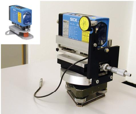
**Abb. 110:** SICK DME500 mit Langlochmontierung (links) und mit Dreifußadaption (rechts).
