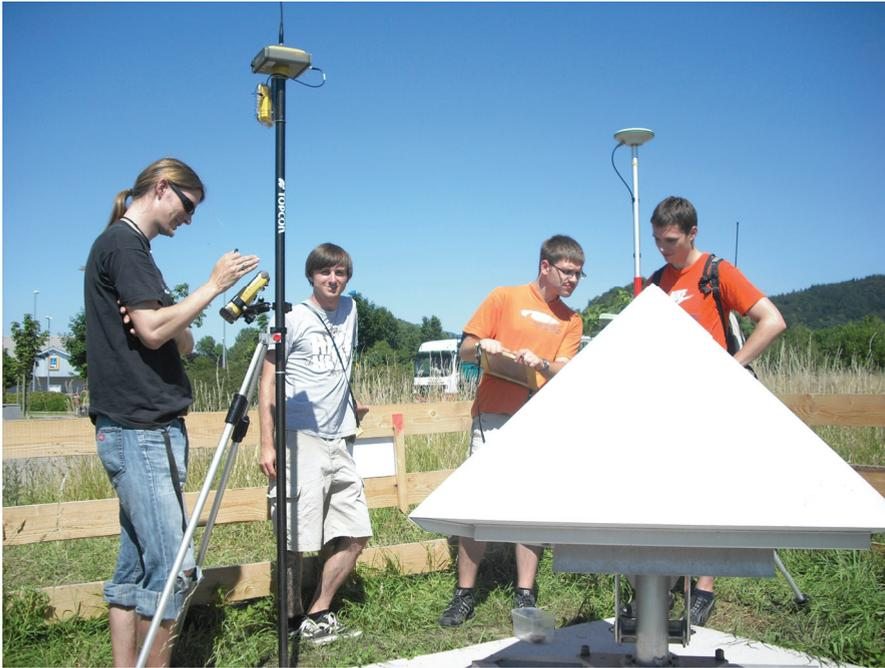
**Abb. 160:** NRTK GNSS-Messung im Jahr 2009 mit Topcon- und Leica-Ausrüstungen zur Einmessung des Fundaments eines InSAR-Corner-Reflektors. Der parallele Einsatz von zwei unterschiedlichen NRTK-Ausrüstungen unter gleichzeitiger Nutzung verschiedener Vernetzungsdienste (z. B. SAPOS<sup>®</sup>, AXIONET) ermöglicht erhöhte Zuverlässigkeit und wissenschaftliche Studien.
