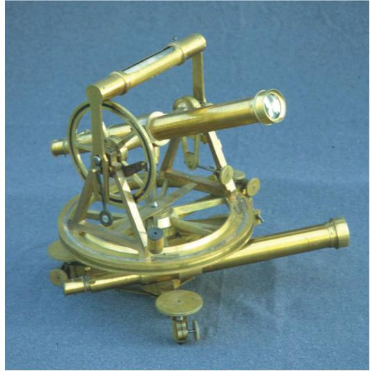
**Abb. 172:** Repetitionstheodolit mit Versicherungsfernrohr (Reichenbach ca. 1823).
