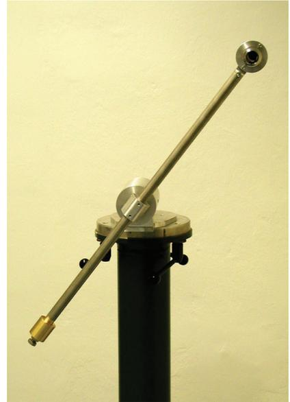
**Abb. 120:** GIK-Eigenkonstruktion der Ballbar.
