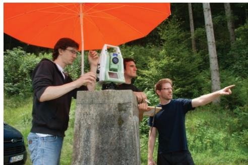
**Abb. 148:** Präzisionstachymeter Leica TS 50.
