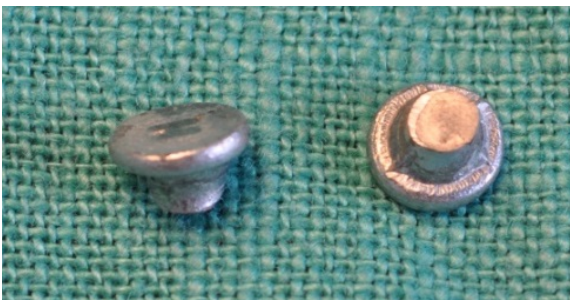
Abb. 8 Nagelscherversagen in Stahlblech-Holz-Verbindungen mit Rillennägeln in Furnierschichtholz aus Buche (oben) und abgescherte Nagelköpfe (unten)
