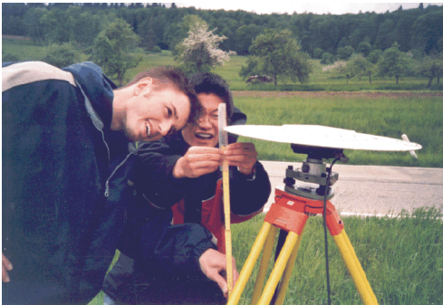
Abb. 158: Die präzise Bestimmung der Antennenhöhe stellt bei statischen GNSS-Messungen einen bedeutsamen Einflussfaktor dar, insbesondere wenn ein ausreichend langer Maßstab fehlt (2004).
