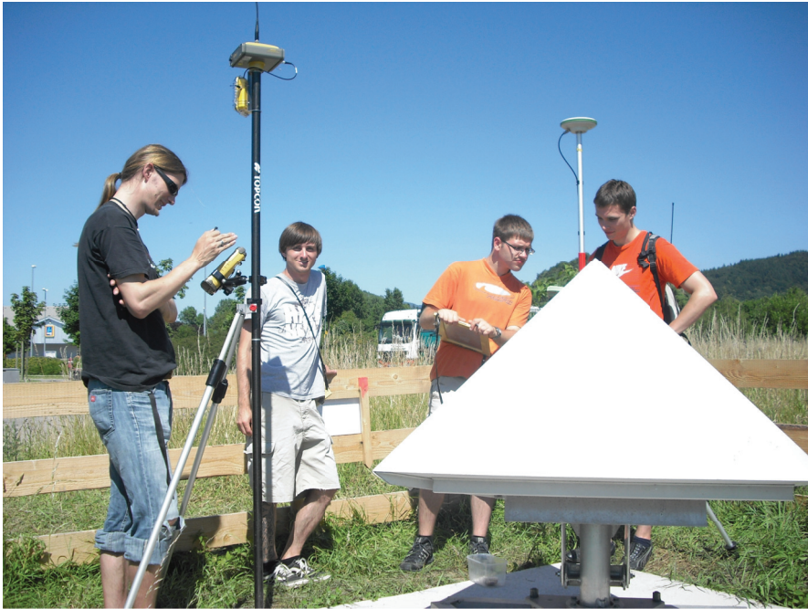
Abb. 160: NRTK GNSS-Messung im Jahr 2009 mit Topcon- und Leica-Ausrüstungen zur Einmessung des Fundaments eines InSAR-Corner-Reflektors. Der parallele Einsatz von zwei unterschiedlichen NRTK-Ausrüstungen unter gleichzeitiger Nutzung verschiedener Vernetzungsdienste (z. B. SAPOS ® , AXIONET) ermöglicht erhöhte Zuverlässigkeit und wissenschaftliche Studien.
