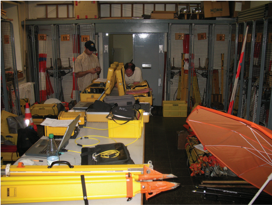
Abb. 157: Die Vorbereitung der GNSS-Empfänger umfasst die Kontrolle des internen Speichers und insbesondere die Konfiguration der Sessionparameter (Epochendauer, minimale Elevation). Oft waren knapp 10 Ausrüstungen im Einsatz (2012).
