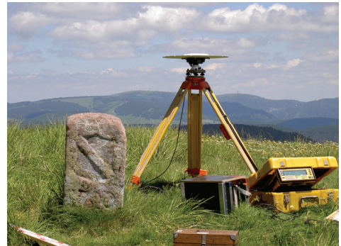
Abb. 162: Statische GPS-Messung auf dem Belchen im Jahr 2009 mit einem Trimble 4000SSI-Empfänger. Zur Sicherstellung der Stromversorgung wurden Autobatterien genutzt.
