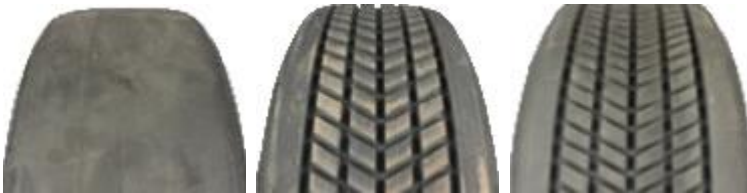
Abbildung 5.5: Profilierung der Reifen zur Modellvalidierung: Glattrreifen, Profil mit konstanter Blockgröße, Profil mit randomisierter Blockgröße (v. l. n. r.)
