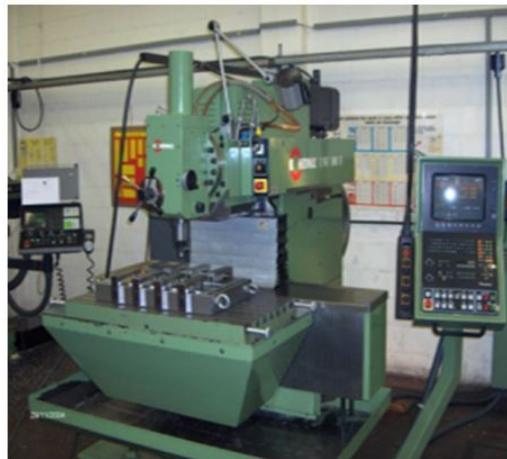
FIGURE 3.12 – Fraiseuse adaptée pour le FSW, à UCL-PRM
