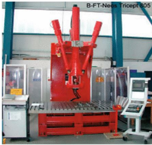
FIGURE 3.14 – Tricept TR805 utilisé en FSW [111]
