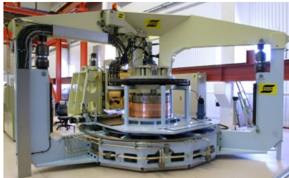
FIGURE 3.16 – La machine FSW de la Société suédoise de combustible et de gestion des déchets nucléaires (SKB)
