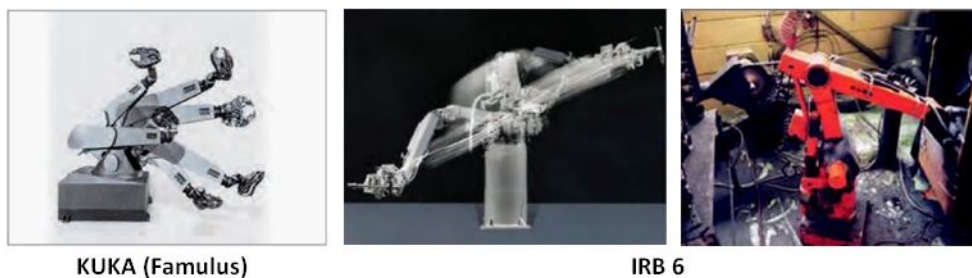
FIGURE 2.3 – Les robots industriels développés entre 1973 et 1974 [43]
