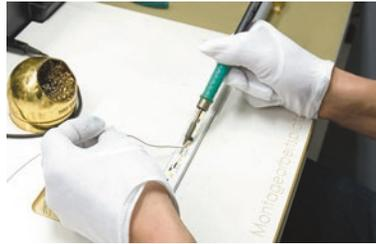
**Abb. 10.3** Manueller Lötprozess von LED-Leuchtbändern
