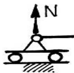
Рисунок 2.5 - Реакция в подвижных катках
