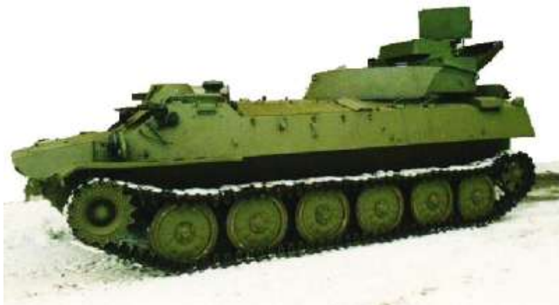
Рисунок 6.8 – Радіолокаційна станція розвідки рухомих цілей СНАР-10
