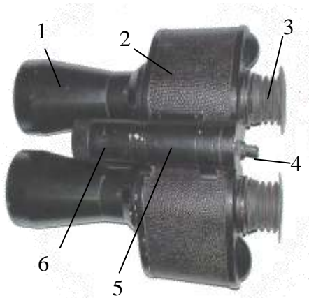
Рисунок 2.48 – Нічний бінокль 1ПНЗЗБ: 1 – об'єктив; 2 – середник; 3– окуляр; 4 – тумблер «Живлення»; 5 – кронштейн; 6 – акумуляторна батарея
