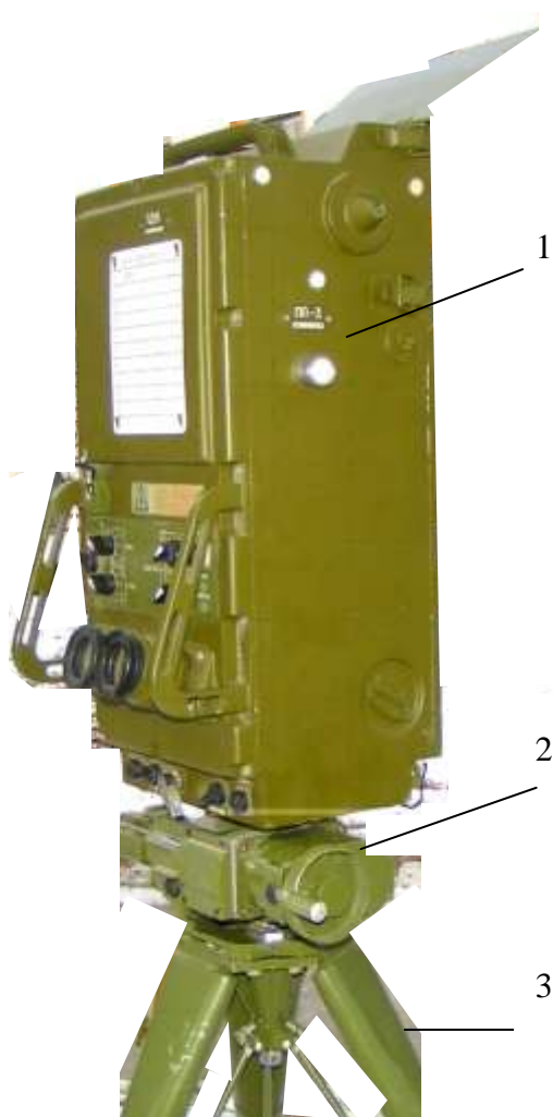
Рисунок 2.36 – Лазерний далекомір-цілевказівник 1Д15: 1 – прийомопередавач; 2 – система наведення; 3 – тринога
