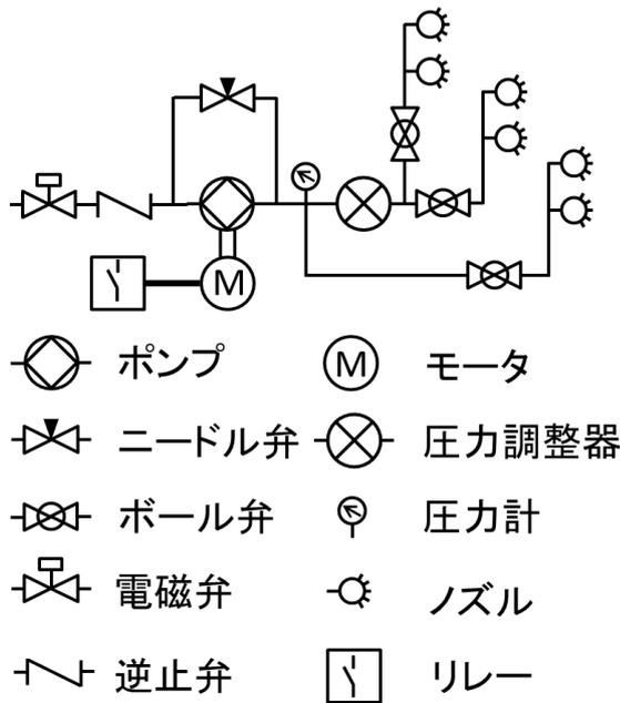
図1 高圧洗浄機の配管系統図
