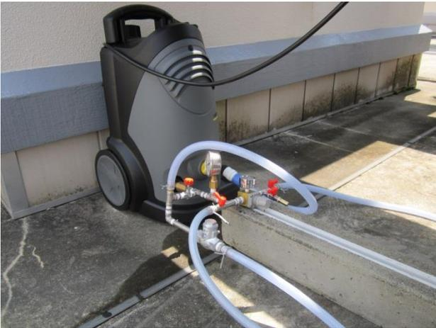
図4 高圧洗浄機と配管類の設置状況
