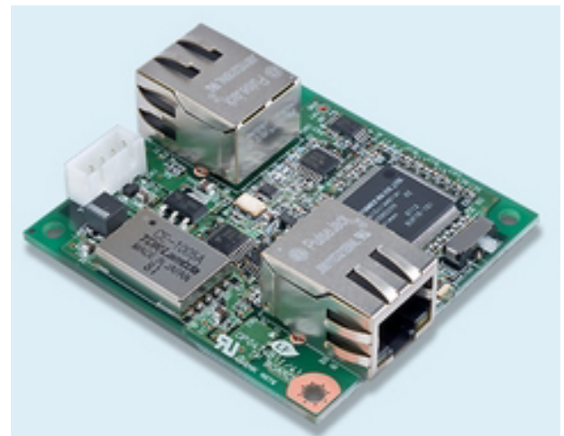
図3 IPsec暗号化アダプターNS-101
