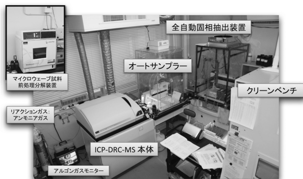
図7 本学医学部保健学棟に設置されているリアクションセル方式誘導結合プラズマ質量分析システム 31)
