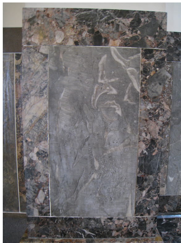
図 14 大阪市立中央公会堂のロビー幅木に使用された「シカマイア大理石」（中央）を額縁風に縁取る「美濃更紗」（いずれも矢橋大理石のある岐阜県大垣市赤坂町金生山産）。
