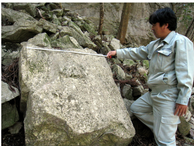
図6 太龍寺の礎石に使用された大理石採石跡と残された加工途中の礎石用石材。(阿南市太龍寺東南のいわや道尾根)。面取り成形の途中で、天面の中央には柱孔のための楔跡が刻まれている。
