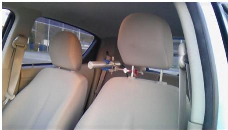
図1 サーベイメータ検出部の固定
