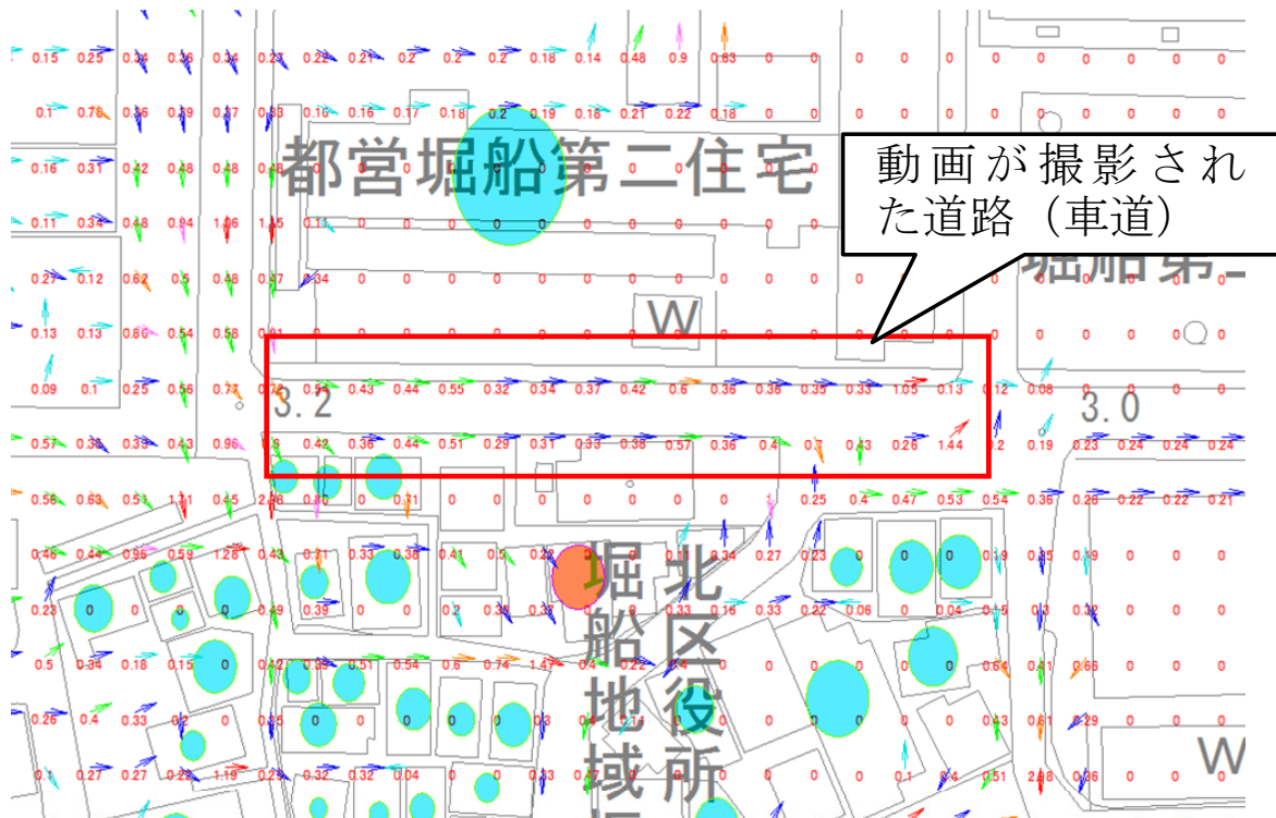
図 3-34 平成 22 年(2010 年)7 月洪水 想定最大流速図
