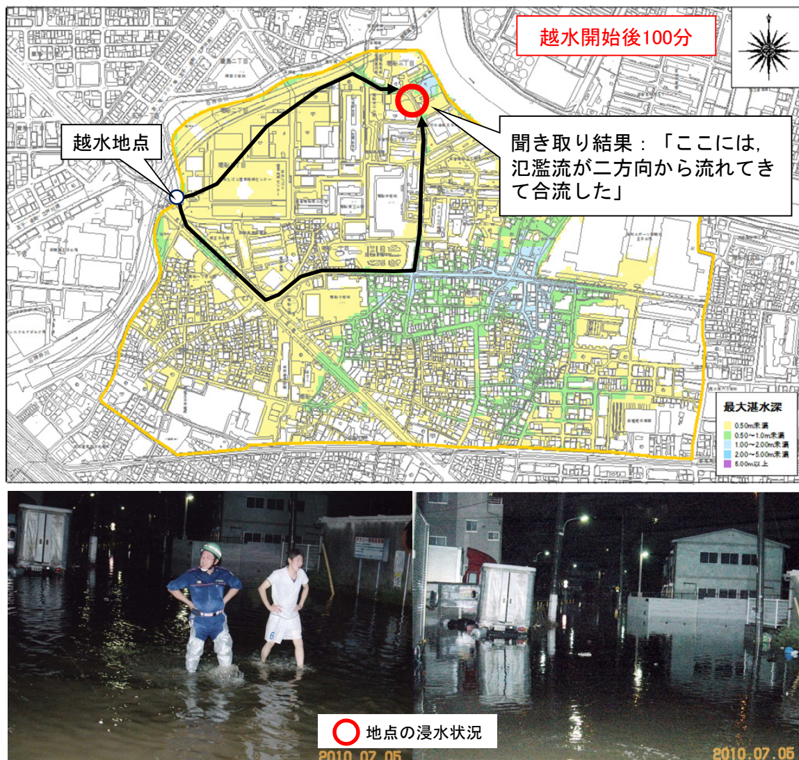
図 3-37 越水開始後 100 分時点の湛水深図
