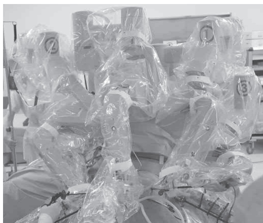
図6 ドッキングの実際：ロボットアームとポートのドッキング。
