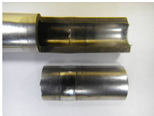
図4 平均電流値を1A上げて溶接したチューブ
