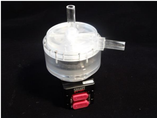
左：図1 シーケンシャルフロー型遠心ポンプ（3次モデル）
