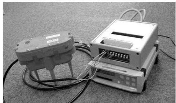
図 1. 白山工業 DATAMARK LS-7000 LS-7000 (右下) と、専用に製作したプリアンプ (右上), 物理探査用地震計 (左, 固有周波数 4.5 Hz, 3 成分).
