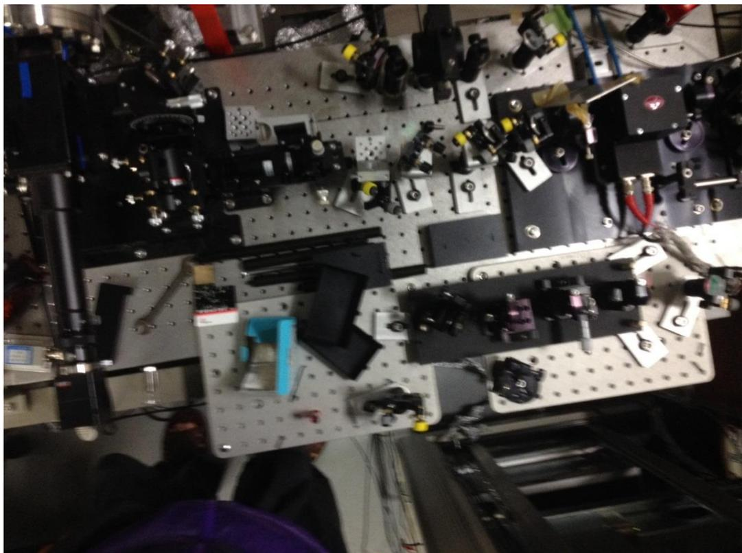
図 2-14 第二・第三高調波出力光学系の模式図(上)と写真(下)
