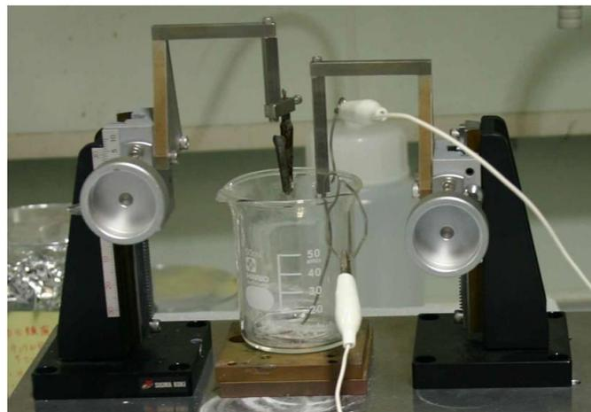
図 2-19 電解研磨装置の写真
