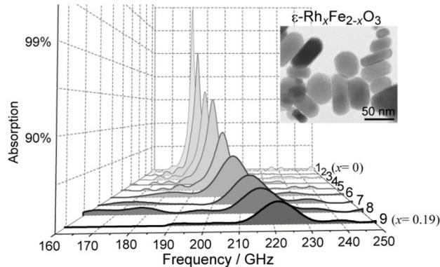
図 3. ゼルゲル合成により得られた  $\epsilon$ -Rh<sub>x</sub>Fe<sub>2-x</sub>O<sub>3</sub> の TEM 像とミリ波吸収スペクトル。
