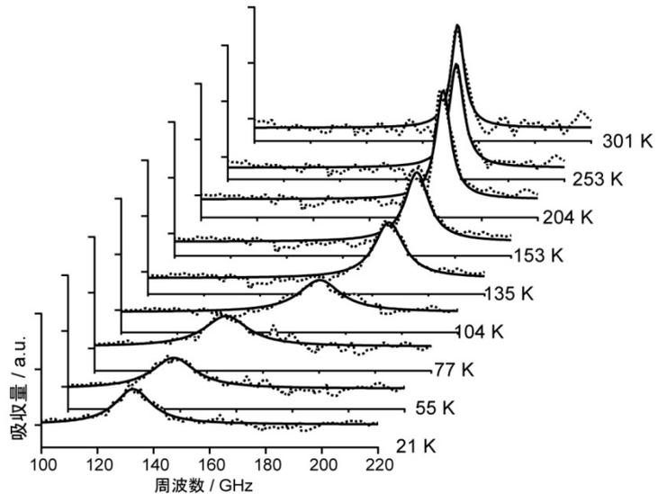
図 5.  $\epsilon\text{-Al}_{0.06}\text{Fe}_{1.94}\text{O}_3$  の電磁波吸収スペクトルの温度依存性。
