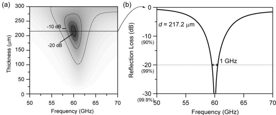
図 4. インピーダンス整合計算により得られた  $\epsilon$ -Ga<sub>0.537</sub>Fe<sub>1.463</sub>O<sub>3</sub> シートの (a) シート厚みおよび周波数に対する反射吸収量分布と (b) 217.2  $\mu$ m 厚シートの反射減衰量の周波数依存性。
