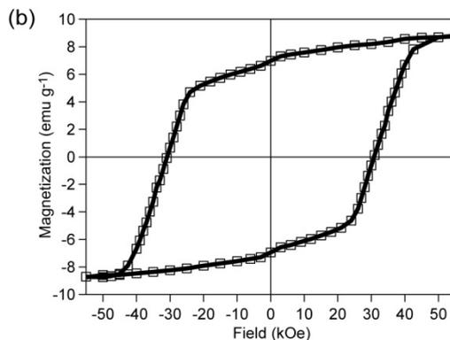
図 1. (a)  $\epsilon\text{-Rh}_x\text{Fe}_{2-x}\text{O}_3$  の結晶構造. (b)  $\epsilon\text{-Rh}_{0.14}\text{Fe}_{1.86}\text{O}_3$  ナノ粒子配向体における磁気ヒステリシス (at 300 K).
