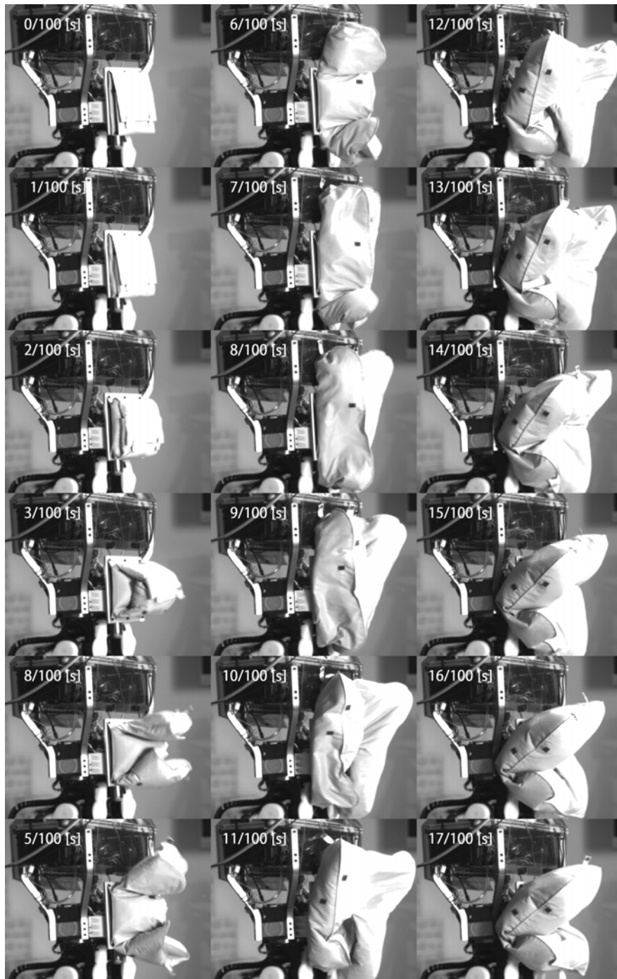
図 3.9: 低通気性素材による緩衝外装の展開速度 (1/2) ; 0.2 ~ 0.3 秒で展開が完了する .
