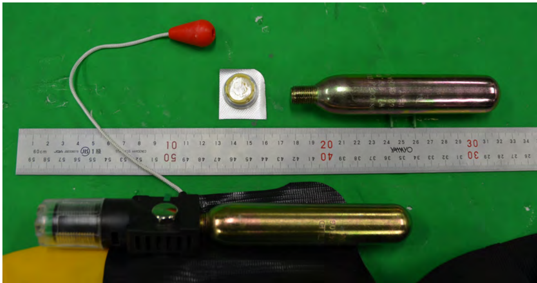
図 4.6: 機械的イニシエータ (瞬間開栓) による OnSUPPLY 社製自動膨張式ライフジャケットのインフレーター；手動ひも展開と水没センサ自動展開の 2 種類で展開する．中央は交換用水没センサ
