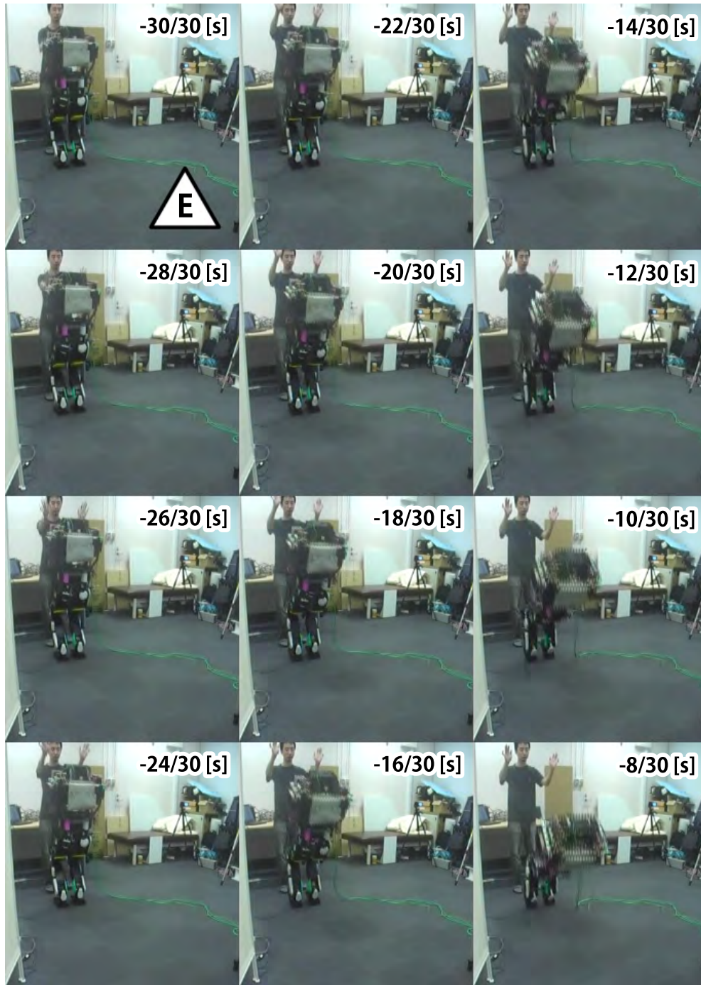
図 6.18: 背面緩衝外装を用いない転倒事故・背面より (1/2)
