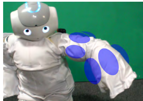
図 B.10: 「柔軟素材 + 形状制限 + 収縮」 構造による NAO 緩衝外装の両腕
