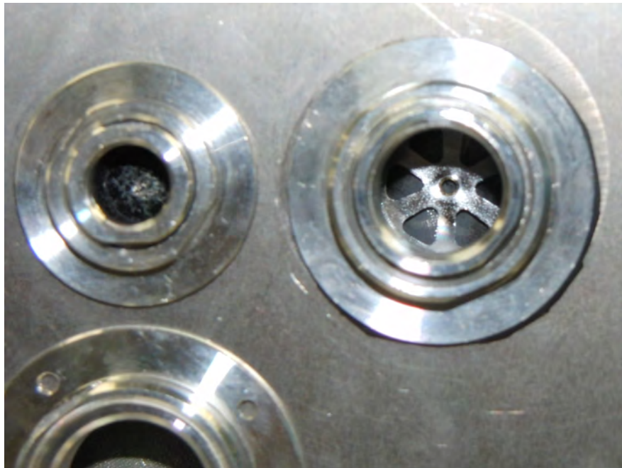
図 5.6: 注入口と排出口の外部からの概観；注入口(左)には直線的注入を防ぐ壁，排出口(右)には張り付き防止のためのキャップが備えられている。
