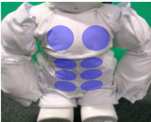
図 B.9: 「柔軟素材 + 形状制限 + 収縮」 構造による NAO 緩衝外装の体前面
