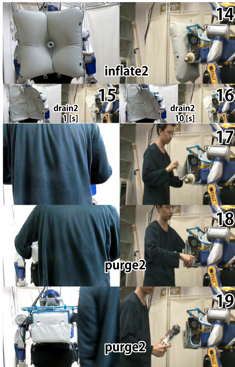
図 6.32: リロード・インフレート・ドレイン動作の繰り返し動作 (3/3)
