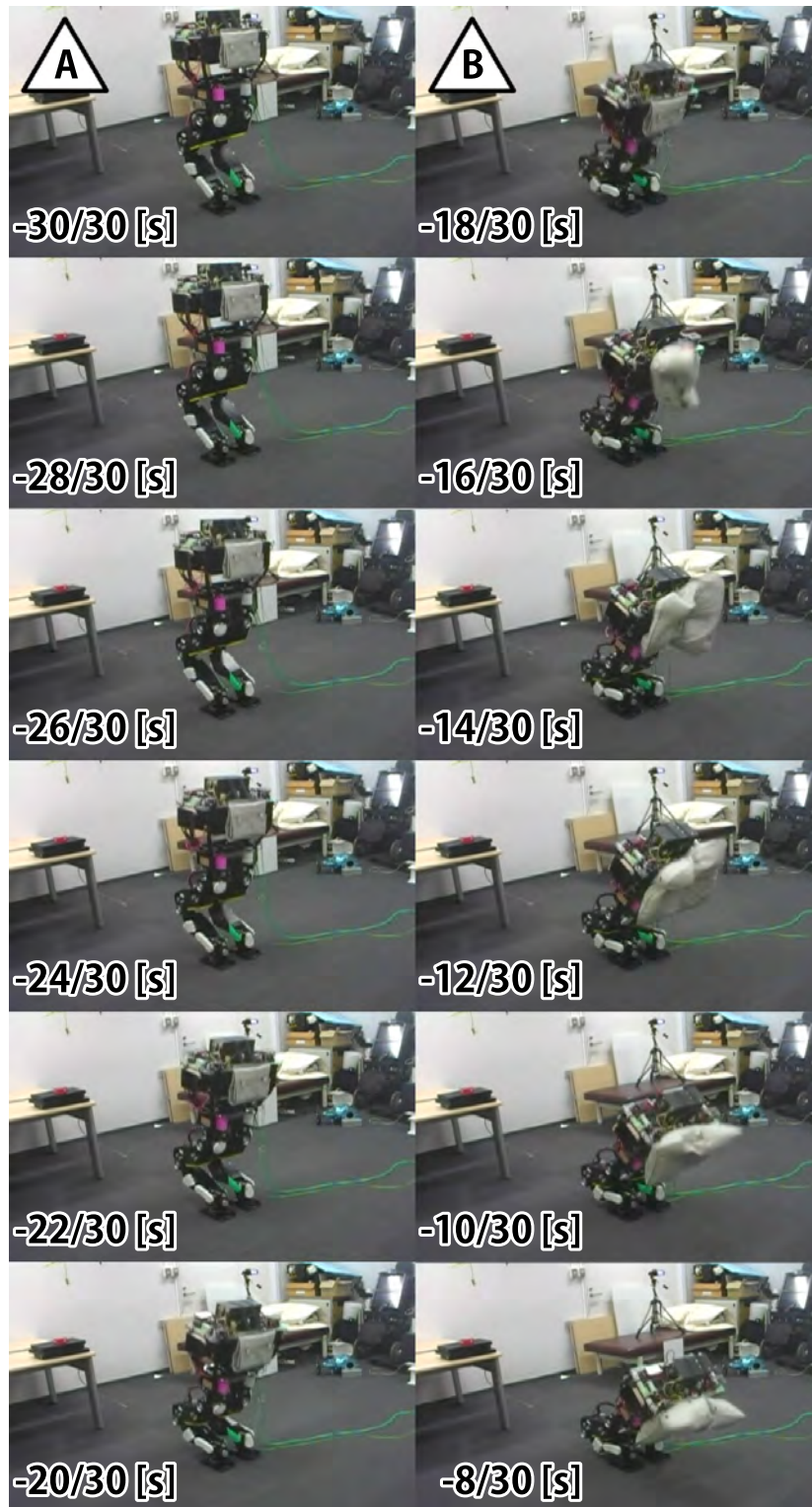
図 6.2: 背面緩衝外装を用いたサーボオフ転倒・背面より (1/2)
