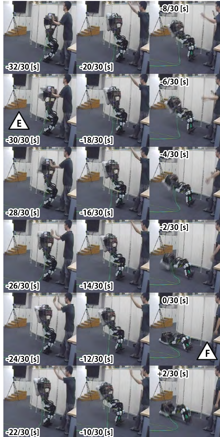
図 6.13: 背面緩衝外装を用いた外力転倒・前面より (1/2)
