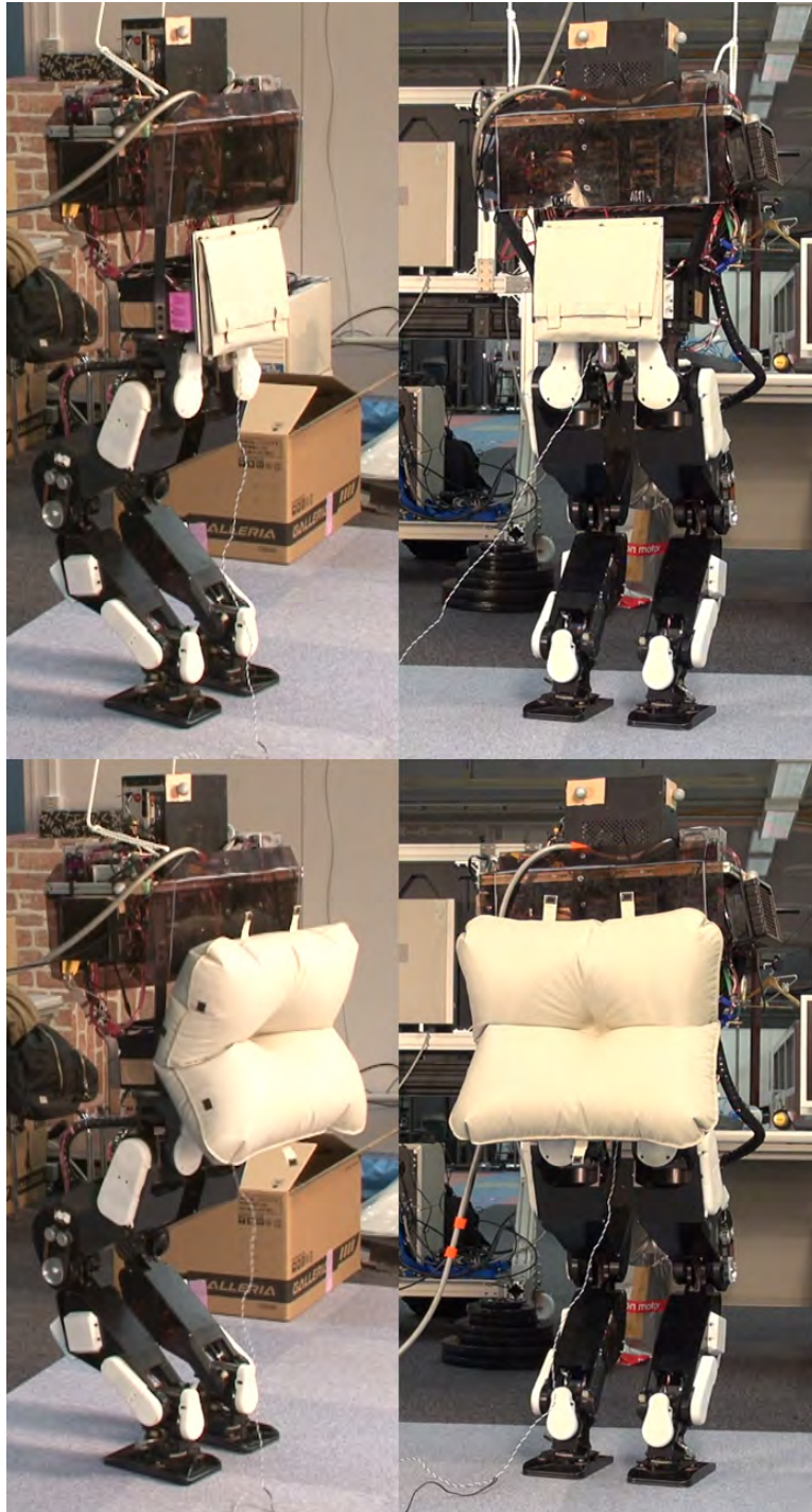
図 3.6: 等身大二脚ヒューマノイドと能動緩衝外装；転倒動作試行の結果第 6 章では腰臀部でなく体幹背面部に設置している。
