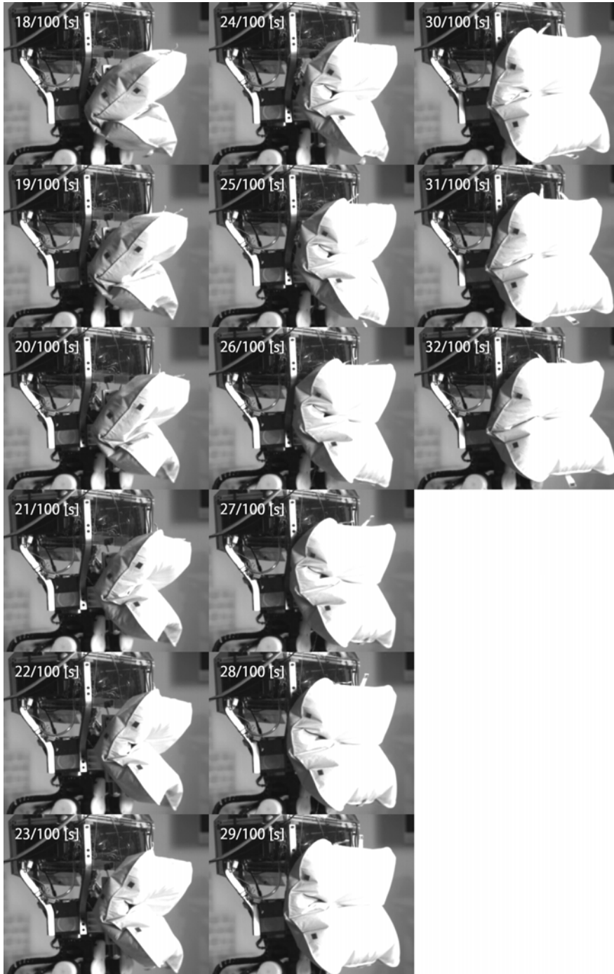
図 3.10: 低通気性素材による緩衝外装の展開速度 (2/2)
