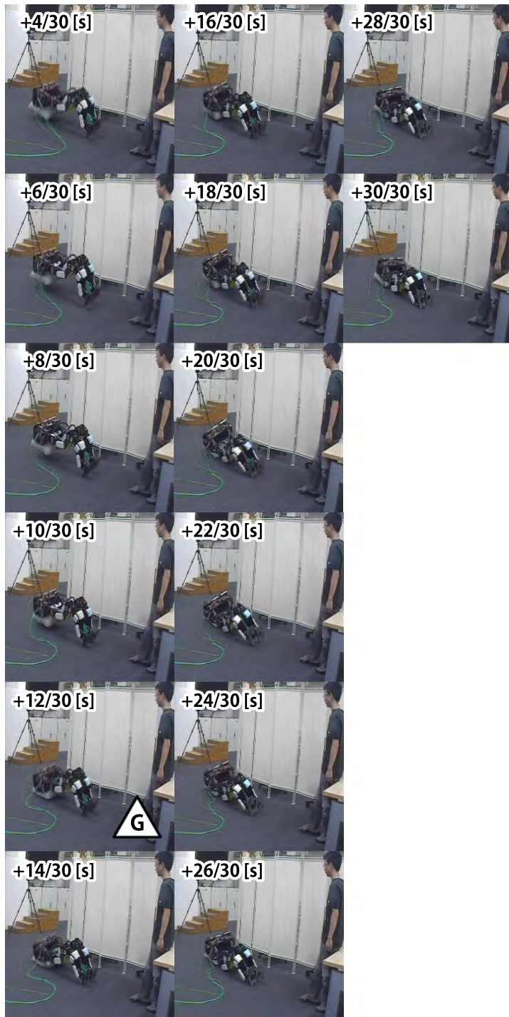
図 6.14: 背面緩衝外装を用いた外力転倒・前面より (2/2)
