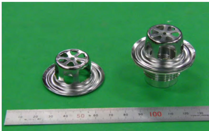
図 5.7: 排出口内部に備えられた張り付き防止のためのキャップ
