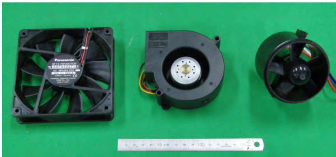
図 5.3: 様々な送風機 (ファン); 左から DC ファンモータ (180g), シロッコファン (180g), ダクテッドファン (240g) の例 .
