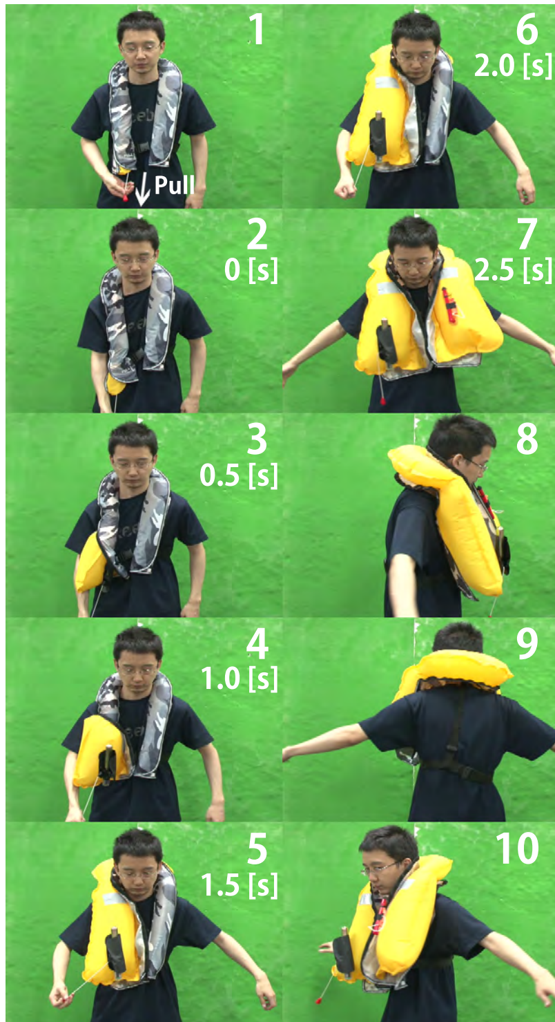
図 4.7: 機械的イニシエータ (瞬間開栓) による OnSUPPLY 社製自動膨張式ライフジャケットのインフレーター展開の概観 .
