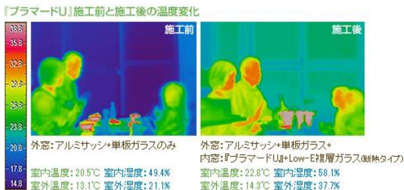
図 3. 2. 2 内窓設置の効果の一例（断熱・遮熱性能）
