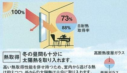
※上記の数値は、「遮熱断熱複層ガラス」「高断熱複層ガラス」はガラス厚3mm+空気層6mm+ガラス厚3mm、「単板ガラス」はガラス厚3mmのときの値。（日本板硝子製の場合）
