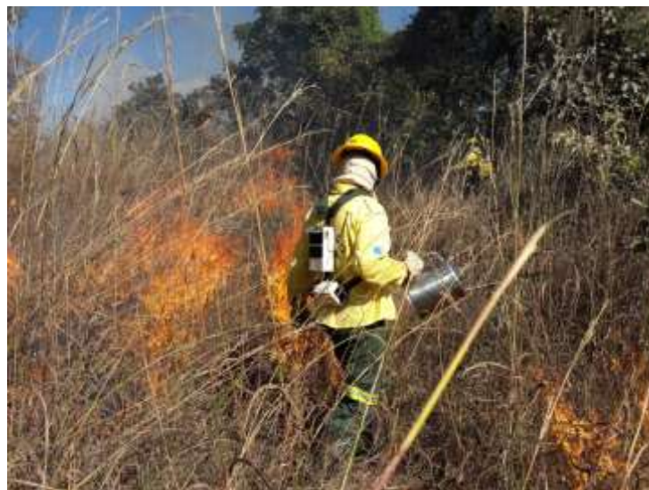
Figura II: Sonda Saphira 3 (versão 4b) fixada sobre as costas de um combatente do PREVFOGO/IBAMA, durante atividade de queima controlada utilizando o pinga-fogo.
