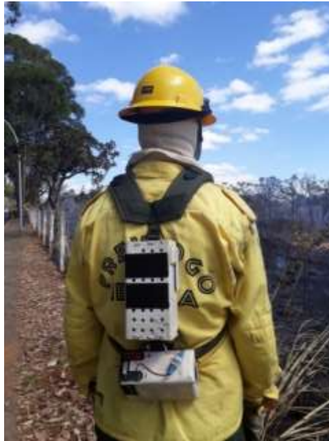
Figura I: Sonda Saphira 3 (versão 4b) colocada sobre as costas do combatente do PREVFOGO/IBAMA. A posição mais próxima possível à cabeça buscou o máximo de correspondência à atmosfera inalada pelo trabalhador.
